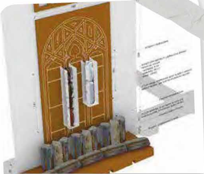
41. ábra. Az osztósudarok és a boltozati bordák bemutatásának látványterve. Konceptió: Bereczki Zoltán, Lovra Éva Rajz: Bereczki Zoltán
